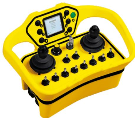
Conductix-Wampfler 康稳 Jay 工业遥控器产品概述：发射器 Orion 系列 Conductix-Wampfler 康稳 Jay 工业遥控器发射器 Orion 系列有 2 种发射器设计：紧凑型发射机，带 2 或 4 个按钮-OREV 多功能发射器，多达 16 个按钮-OREL 两种设计都可以配备一个开/关按钮来打开和关闭发射器，从而避免任何意外操作。室外使用 IP65 无线电传输 433MHz 频段提供 18 个频率。典型范围\*：无障碍区域 150 米；工业环境室内 50 米。金属结构和同在 433 兆赫波段上的其他无线电发射器可能会影响无线电传输，从而降低范围。我们引以为傲的是，我们有能力将无线电传输系统集成到所有类型的电气或电子架构中。四川无线工业遥控器
